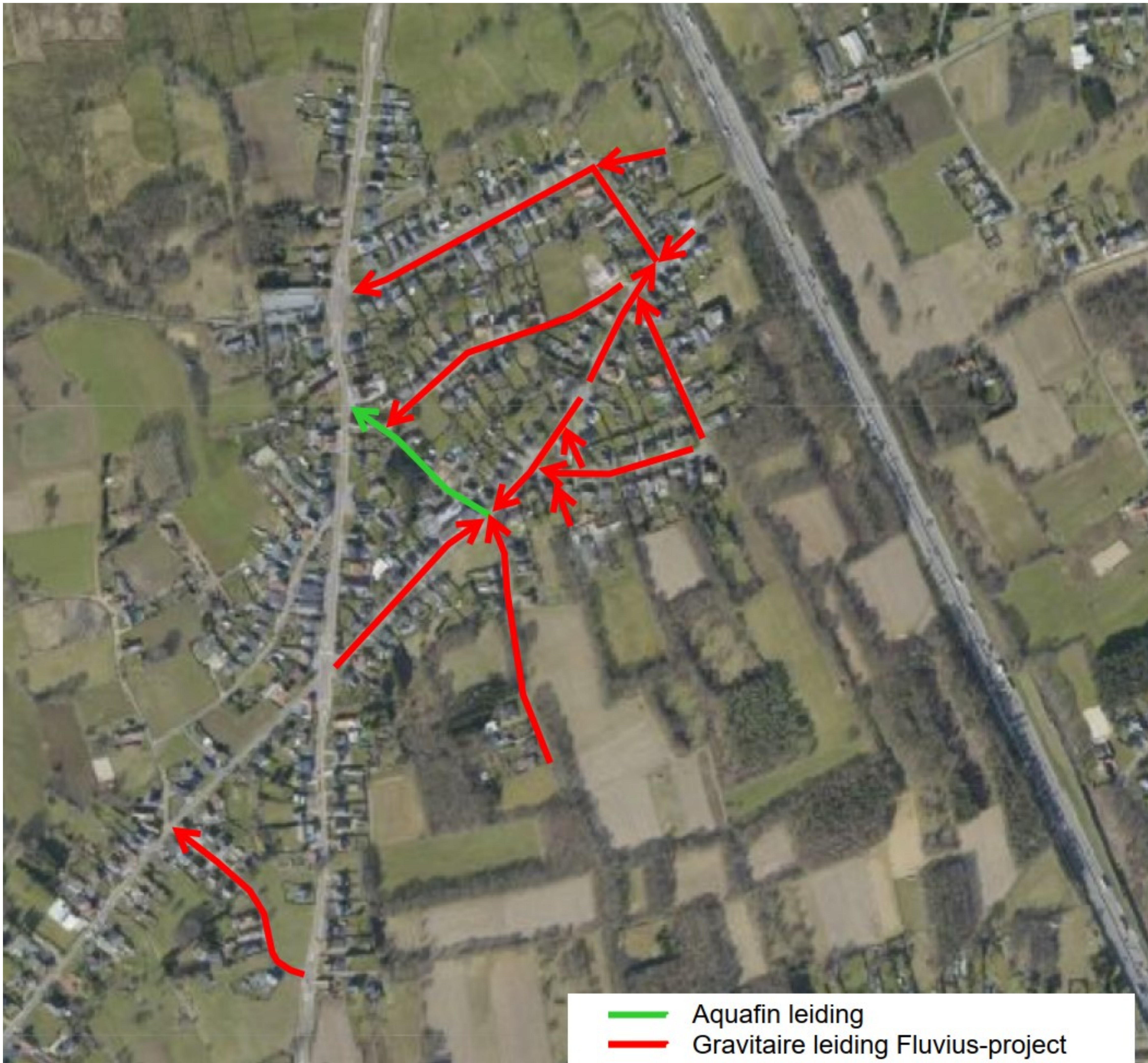
Schema afwatering vuilwater
